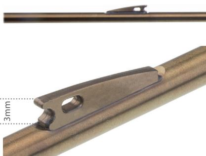
Varilla INOX 17-4PH. Tetones fabricados con tecnologia M.I.M (Metal Injection Molding) montados con soldadura laser. Nueva aleta con perfil escalonado, disponible en mono aleta. Aletilla no encajada
