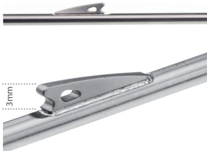
Varilla en acero SANDVIK Tetones fabricados con tecnologia M.I.M (Metal Injection Molding) montados con soldadura laser: Punta tricuspid para una perfecta perforación
