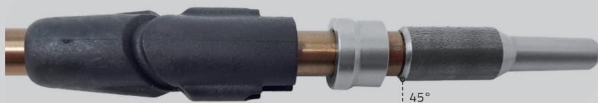
Culatin con perfil de angulo 45° que reduce sensiblemente el impacto con el amortiguador del cabezal Vuoto mejorando y alargando la vida util.
